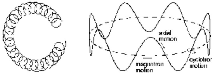
Figura 4.6: Proiezione sul piano radiale del moto di una particella carica in una trappola elettromagnetica di Penning (sovrapposizione del moto di magnetron e del moto di ciclotrone) e moto totale risultante (dove si tiene conto anche dell'oscillazione assiale).
