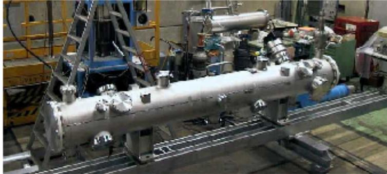
Figura 2.14: La trappola a radio-frequenza (RFQ) utilizzata dall'esperimento ASACUSA.
