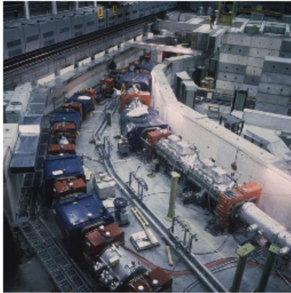
Figura 2.4: Foto dall'alto dei due anelli acceleratori del CERN: AC ed AA.
