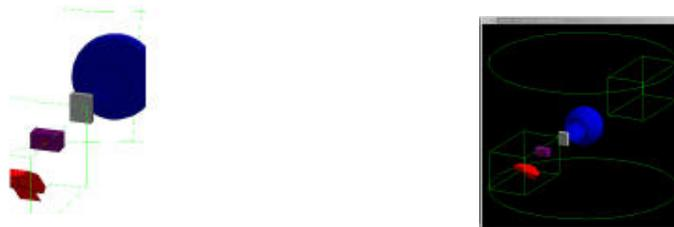
Figura 3.3: Rappresentazione grafica 3D di volumi definiti in un programma di simulazione attraverso le classi di Geant4.
