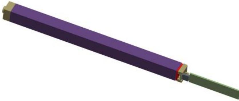
Figura 2.9: Assemblaggio per il singolo cristallo. Questo comprende il blocco di PEEK, sul lato anteriore, il cristallo avvolto dal film 3M Virkuti, il LAAPD fissato nell'incavo di PEEK sul lato posteriore del cristallo e la connessione con l'amplificatore FT-Orsay.
