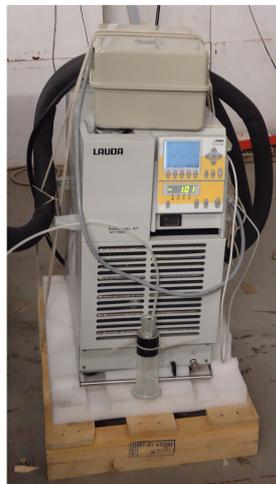
Figura 3.5: Il termostato LAUDA RTK20 utilizzato per il raffreddamento del prototipo.
