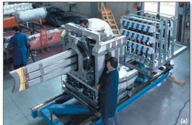
Fig. 9.2 a-b Assemblaggi di guide d'onda per i Gyrotron di FTU
