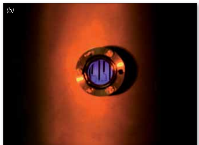
Fig. 15.1 Il Magnetron Sputtering operante a Padova presso il Consorzio RFX: (a) vista esterna della camera da vuoto; (b) foto del plasma del magnetron attraverso uno degli oblò della camera da vuoto
