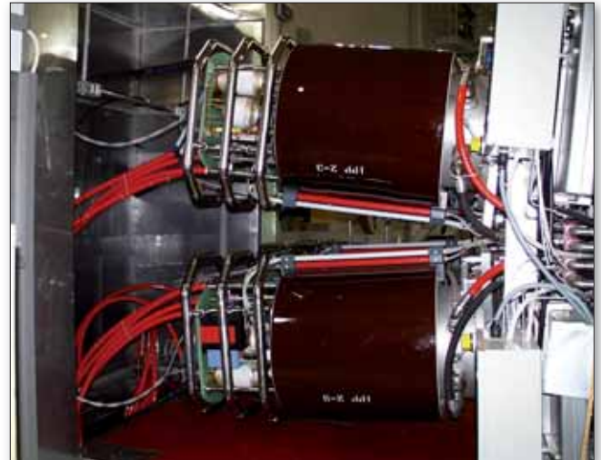
Fig. 9.1 Vista d'insieme di un Gyrotron costruito per il Tokamak di Frascati FTU
