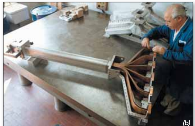
Fig. 9.2 a-b Assemblaggi di guide d'onda per i Gyrotron di FTU
