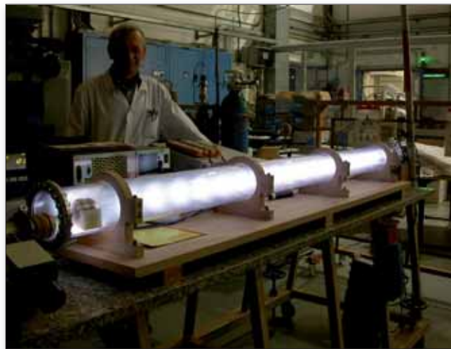
Fig. 5.4: Un esperimento lineare su plasmi freddi ("Mellatron") simile ai primi esperimenti sui plasmi: la colonna luminosa è un plasma di Argon
