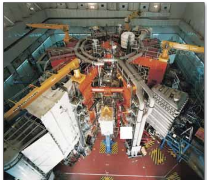
Fig. 9.4 Un iniettore di neutri di JET
