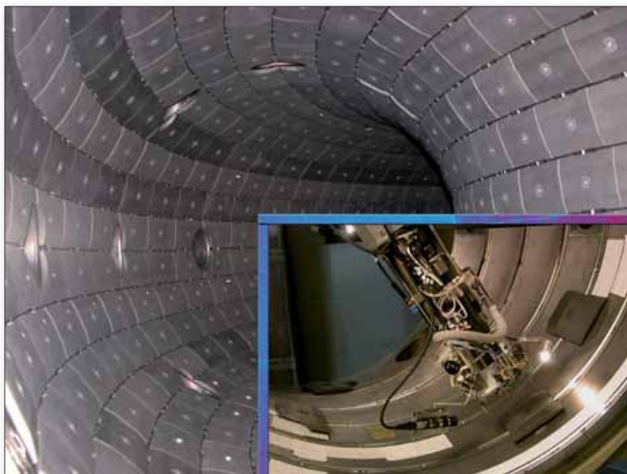
Fig. 14.5 Fotografia dell'interno di RFX con la copertura in grafite e robot per la manipolazione a distanza
