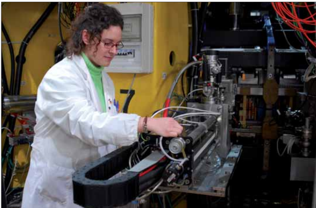
Fig. 14.11 Esempio di attività di sviluppo su una diagnostica di RFX: ottimizzazione del modulo orizzontale della tomografia a raggi X
