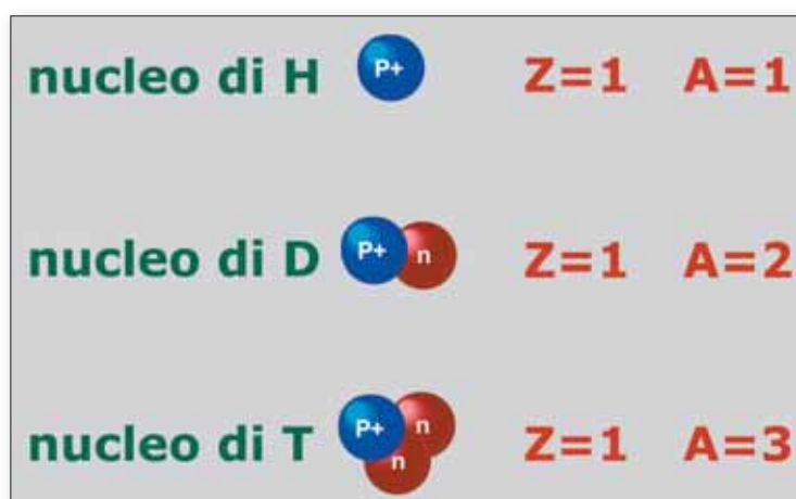
Fig. 2.3 Modello di Rutherford dei nuclei dei tre isotopi dell'idrogeno
