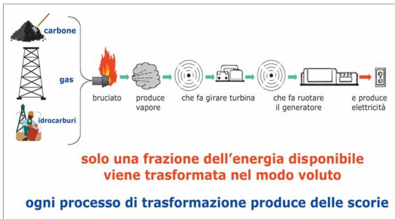
Fig. A.3-a Schema di principio dell'impiego di combustibili fossili per la produzione di energia elettrica
